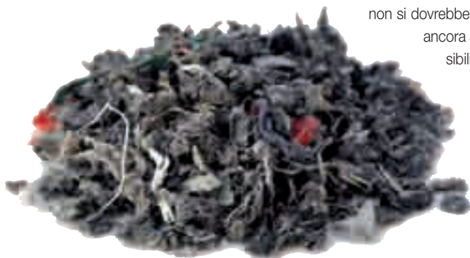
Da alcuni anni Idealservice e Corepla hanno avviato un'attività di riciclo delle plastiche miste finalizzata alla produzione di agente riducente per acciaierie, il cosiddetto SRA (Secondary Reduce Agent) mostrato in foto
