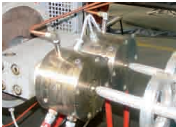
Per aumentare la produttività delle linee per l'estrusione di tubi espansi è possibile utilizzare più teste contemporaneamente
