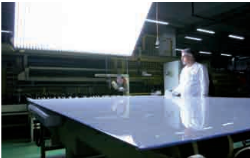
Le lastre in Plexiglas vengono utilizzate negli elicotteri per garantire una chiara visione panoramica ai piloti. In foto: controllo qualità delle lastre per il settore aeronautico nello stabilimento di Evonik a Weiterstadt, in Germania
