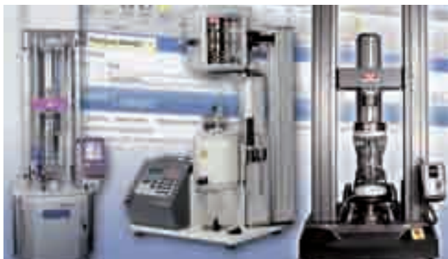
Al K 2013 Instron ha presentato sistemi per la misurazione della fluidità e delle proprietà meccaniche dei materiali termoplastici, compreso il comportamento dei componenti sotto carico statico e dinamico
