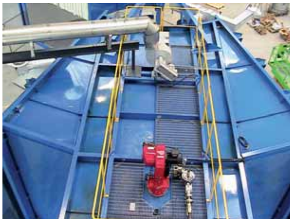
Il nuovo sistema Exhaust Gas Modulation (EGM) permette di evacuare solo i fumi incombusti (CO e NOx), senza estrarre inutilmente aria calda
