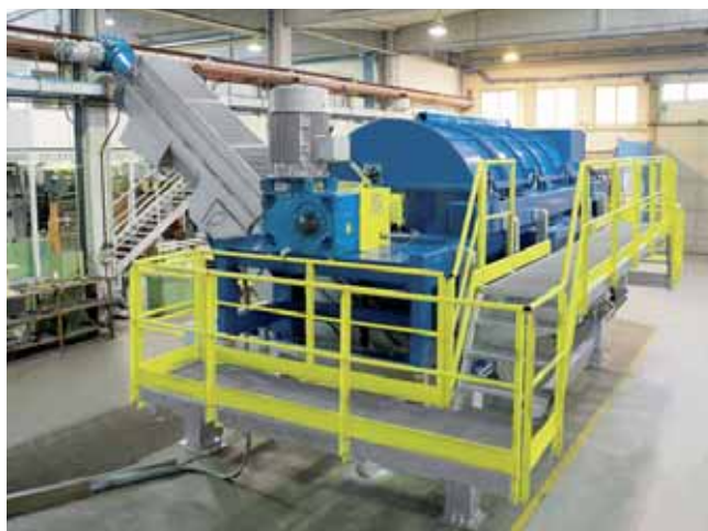
La nuova unità per la rimozione delle etichette termoretraibili dalle bottiglie in PET post consumo negli impianti di lavaggio e riciclo
