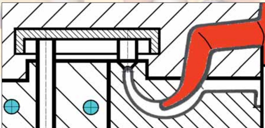
Fig. 2 - La rottura del tunnel a banana è dovuta all'eccessiva rigidità del materiale plastico rinforzato
