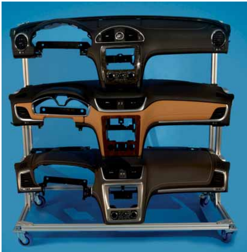
I vincitori nella categoria "Interni auto" e vincitori assoluti del premio SPE: sistemi plancia in resine poliolefiniche, "cuciti" con una speciale tecnologia e morbidi al tatto
