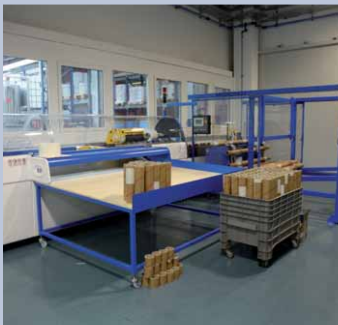
Il dispositivo TCAG per la giunzione e il taglio di anime in automatico
