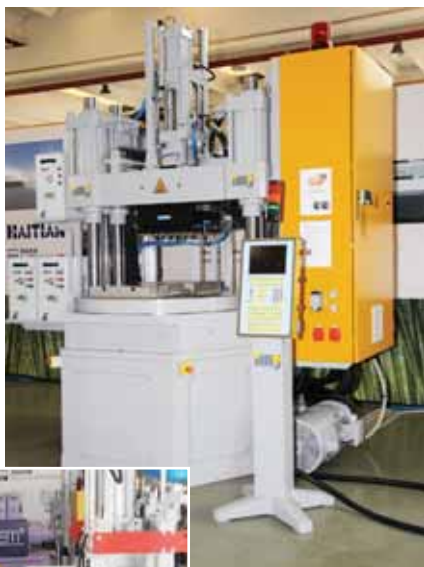
Pressa verticale da 150 t con tavola rotante a due piani termoregolati per il sovrastampaggio di inserti
