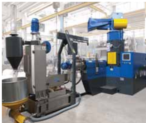
Il modello GM50 Compac, il più piccolo di questa serie, con il nuovo design che caratterizzerà tutte le linee di Gamma Meccanica fino al modello GM90
