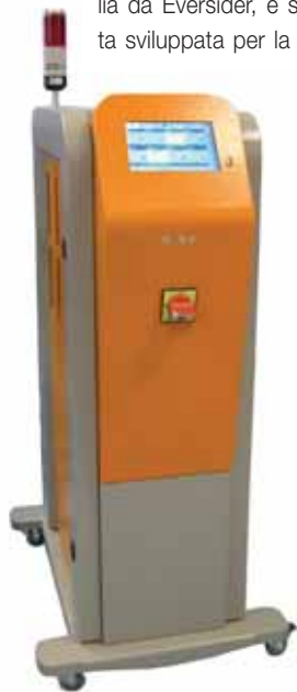
La centralina Serie MV2 consente di regolare la temperatura degli stampi a canali caldi con un elevato numero di ugelli
