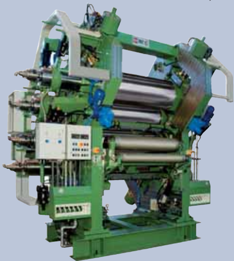
I sistemi Hydrogap e Hydronip sono stati sviluppati da Comerio Ercole per il controllo rispettivamente della posizione e della forza dei cilindri
