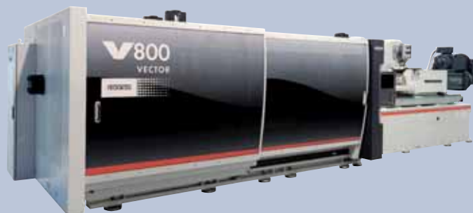
Macchina a iniezione Vector nella versione con forza di chiusura da 800 tonnellate
