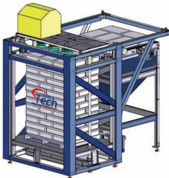
Rendering del sistema di depalettizzazione, taglio e svuotamento sacchi, uno dei prodotti presentati al K 2013 da Main Tech
