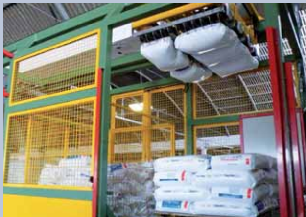
Il sistema automatico LaborSave per lo svuotamento dei sacchi, sviluppato da Ayal Robotics, è distribuito in Italia da Leone
