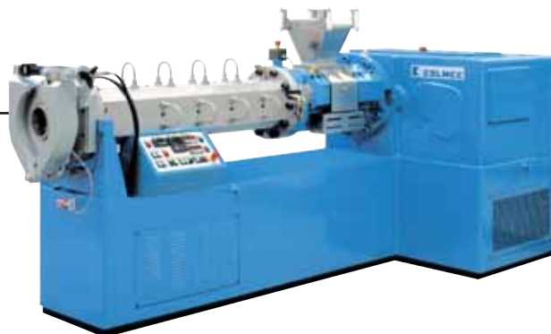
Il raffreddamento dei pioli negli estrusori tangenziali sottrae energia alla mescola, permettendo di aumentare la rotazione della vite mantenendo basse temperature di estrusione
