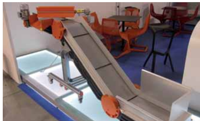
La costruzione modulare dei nuovi nastri trasportatori di Fratelli Virginio consente di configurarli in funzione delle specifiche esigenze dell'utente
