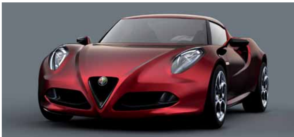
Il peso totale della carrozzeria dell'Alfa Romeo Coupé 4C è di 70 kg, ma per la versione Usa si sale a 100 kg
