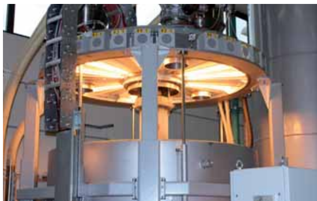
Reattore Moby con coperchio aperto e lampade in funzione
