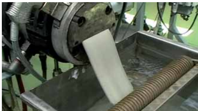
Materiale vulcanizzato in uscita dalla filiera di un estrusore Maris
