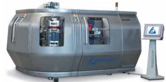
La macchina punzonatrice rotante a doppio utensile e a tre stazioni Star-R 32 consente di realizzare qualsiasi tipo di scope e spazzole, lavorando due articoli alla volta
