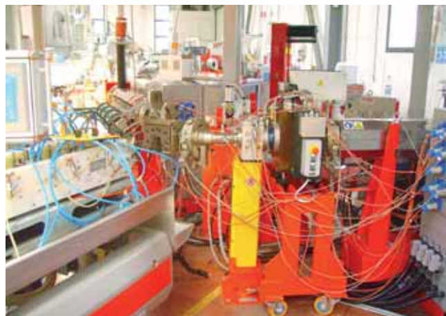
L'impianto messo a punto da Friul Filiere per coestrudere guarnizioni auto rinforzate consente di controllare costantemente e precisamente la produzione in modo semplice e intuitivo
