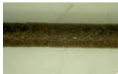
Figura 2 - Estruso di WPC caricato al 40% nella regione di bassa velocità di deformazione (sinistra) e alta velocità di deformazione (destra).
