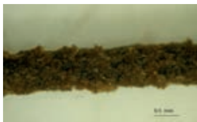
Figura 2 - Estruso di WPC caricato al 40% nella regione di bassa velocità di deformazione (sinistra) e alta velocità di deformazione (destra).
