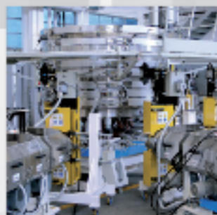
Impianto a 3 strati di ultima generazione per film agricolo (larghezza aperta fino a 22 m con diametro 2000 mm)
