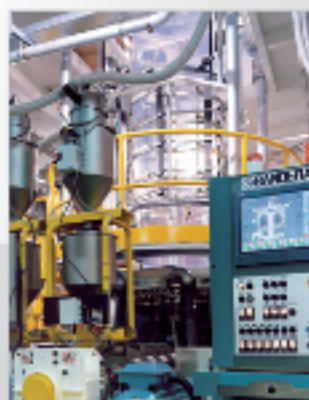
Impianto completo di coestrusione a 5 strati per la produzione di film barrierati per imballaggio
