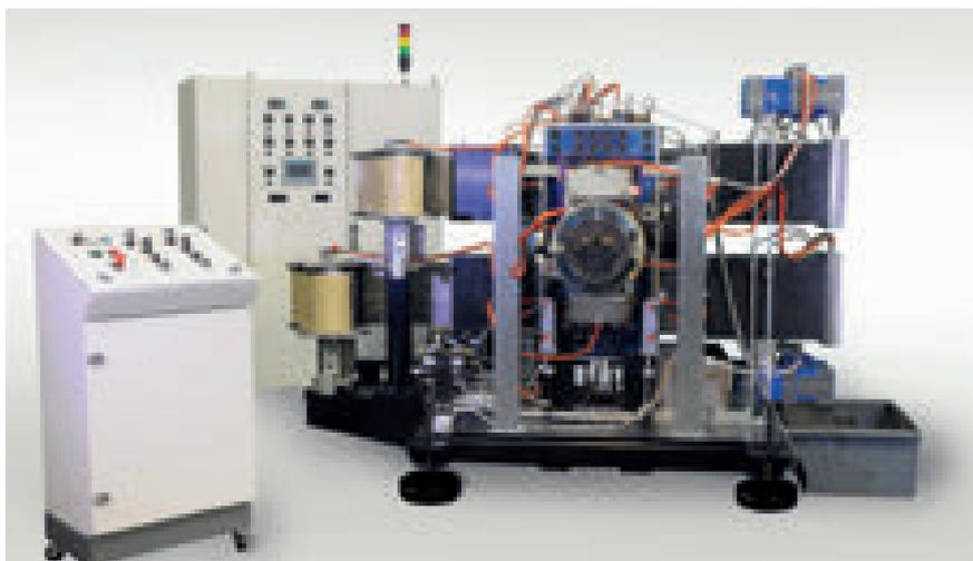
L'innovativo cambia filtro automatico a nastro Principe Evo, con quadro di comando e relativo armadio elettrico
