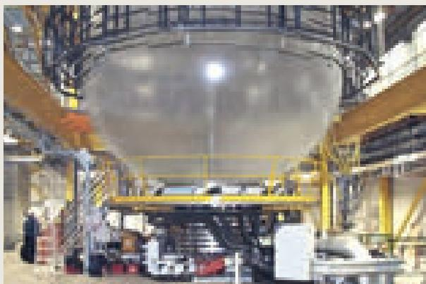
Dettaglio di un impianto per la produzione di film agricolo
