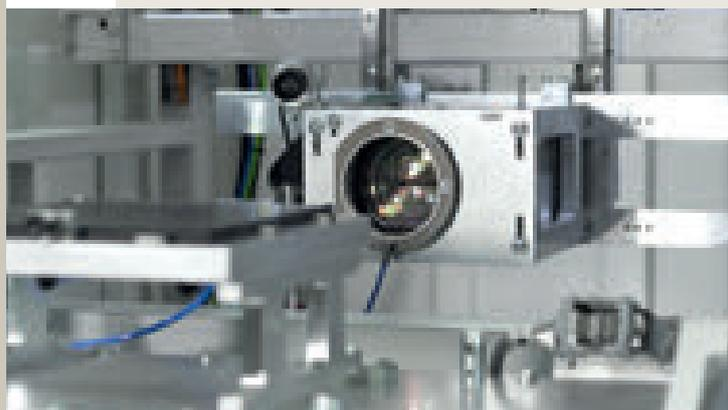
Un particolare della macchina LasIR K3650 per la saldatura laser a infrarossi, che coniuga due tecnologie in una
