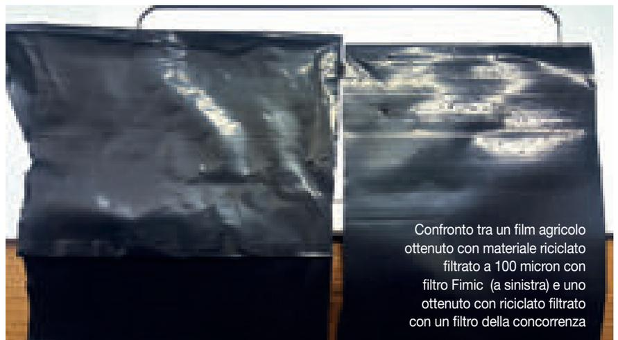
Confronto tra un film agricolo ottenuto con materiale riciclato filtrato a 100 micron con filtro Fimic (a sinistra) e uno ottenuto con riciclato filtrato con un filtro della concorrenza
