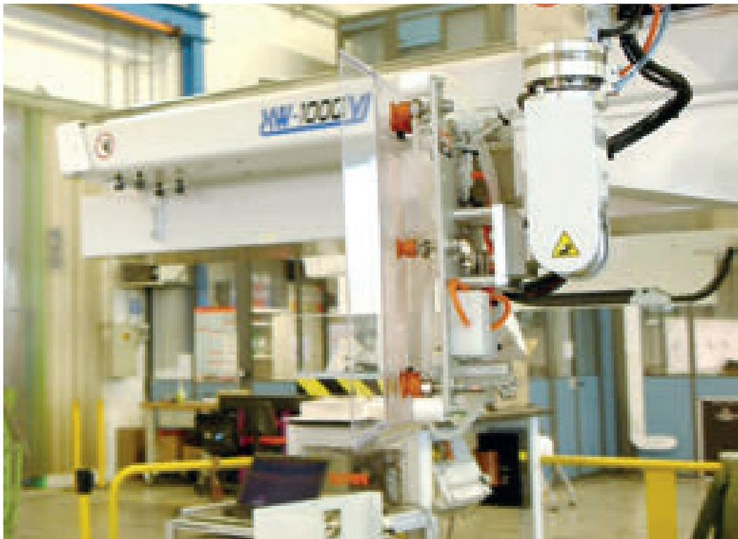
La versione "top entry" di un sistema IML con robot XW-1000VI a entrata verticale - il modello più venduto della serie XW-VI, che coniuga insieme efficienza e accuratezza - è stata recentemente presentata da Star Automation Europe a Mecspe 2017 (Parma, 23-25 marzo). Il sistema - installato su una pressa BMB eKW 25Pi, che produceva un vassoio in PS cristallo con uno stampo a una cavità - prelevava le etichette dal relativo magazzino a una postazione, dotato di centraggi e fissato a terra.
