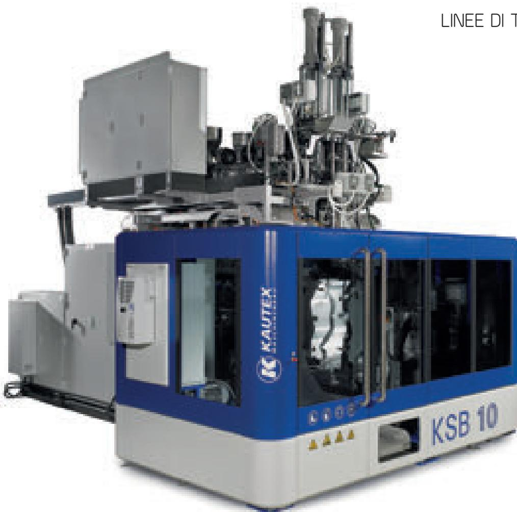
I MODERNI MATERIALI PLASTICI A ELEVATE PRESTAZIONI E TERMORESISTENTI PERMETTONO OGGI DI PRODURRE TRAMITE SOFFIAGGIO 3D COMPLESSE TUBAZIONI PER IL SETTORE AUTOMOBILISTICO, IN GRADO DI SERVIRE ANCHE I MOTORI TURBO ESPOSTI A FORTI SOLLECITAZIONI. I RIDOTTI TEMPI DI RIATTREZZAGGIO DELLE SOFFIATRICI IN ASPIRAZIONE APRONO A QUESTO RIGUARDO NUOVI POTENZIALI ECONOMICI
