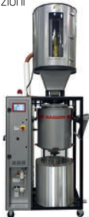
Il modello VBD 300 raggiunge una capacità di produzione di 136 kg all'ora: il doppio rispetto al modello VBD 150
