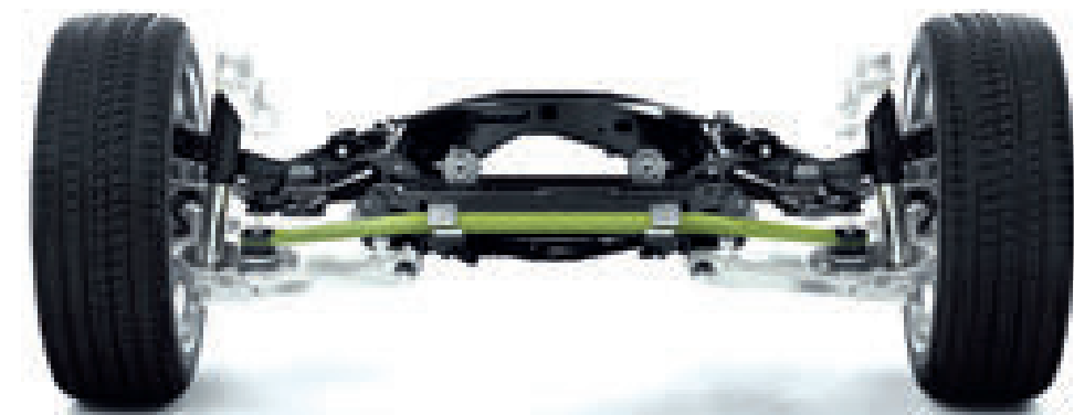
La nuovissima sospensione posteriore del SUV crossover Volvo XC90
