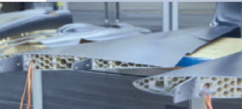
L'UAV di Aurora dimostra che la soluzione di stampa 3D basata sulla tecnologia FDM di Stratasys è in grado di creare una struttura cava completamente chiusa, che permette di produrre oggetti di grandi dimensioni ma meno densi
