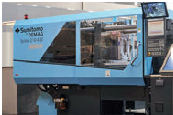
La Systec Servo 210, cuore pulsante dell'isola per lo stampaggio a iniezione dello schiaccianoci leggero
