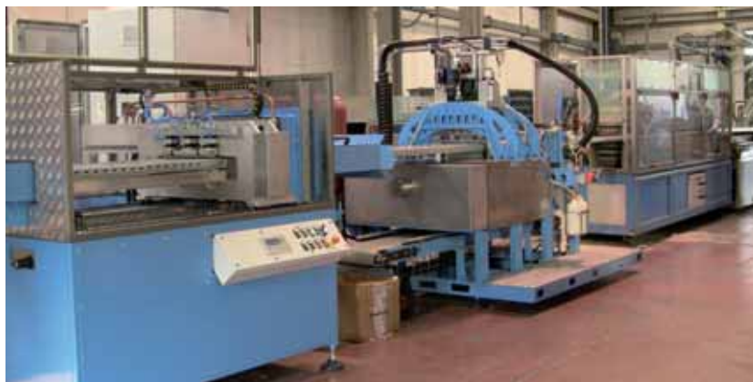
Конечной участок линии, оборудованный под выполнение операций вырубки и резки кабельных лотков больших размеров
