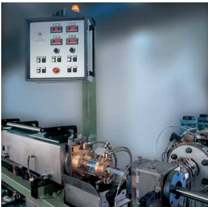
Экструзионная линия, разработанная компанией Profile Dies для изготовления ирригационных шлангов с плоскими капельницами
