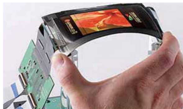
Фосфоресцентные органические элементы (Phosphorescent Organic Light-Emitting Diode - PHOLED) являются производными от технологии OLED и обеспечивают существенно более высокую эффективность в эксплуатации
