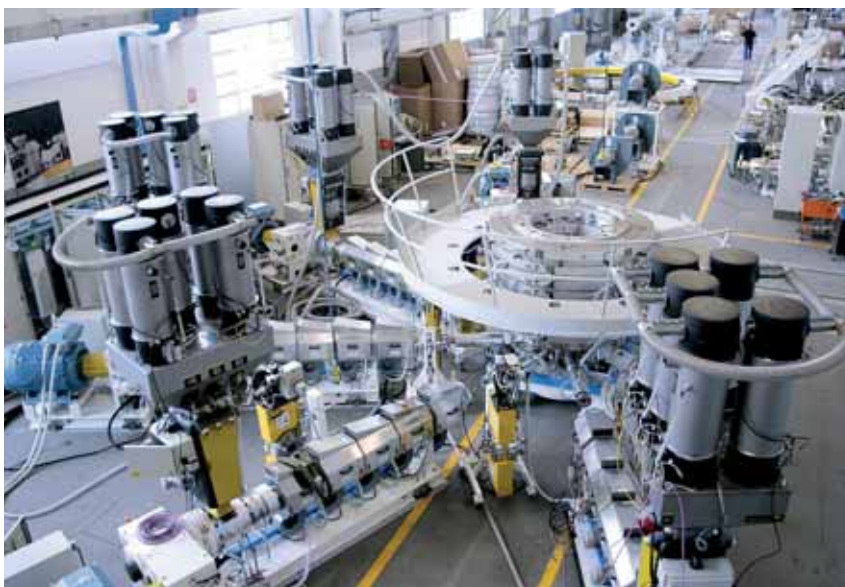
Набор экструдеров и головка, разработанные компанией Bandera для производства выдувных пленок
