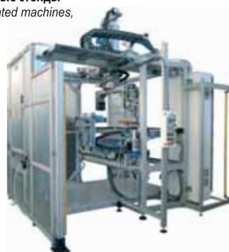
Роботизированные стенды (ячейки) для изготовления гармошек для переднего и заднего бампера, а также для дверец автомобилей Robotized island (cell) rear bellows, front bellows, car door bellows
