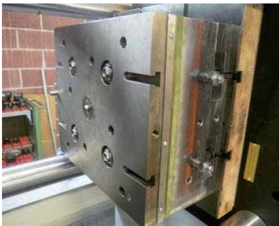
Многофорсуночная прессформа с блоком терморегулирования, разработанная компанией OCS
