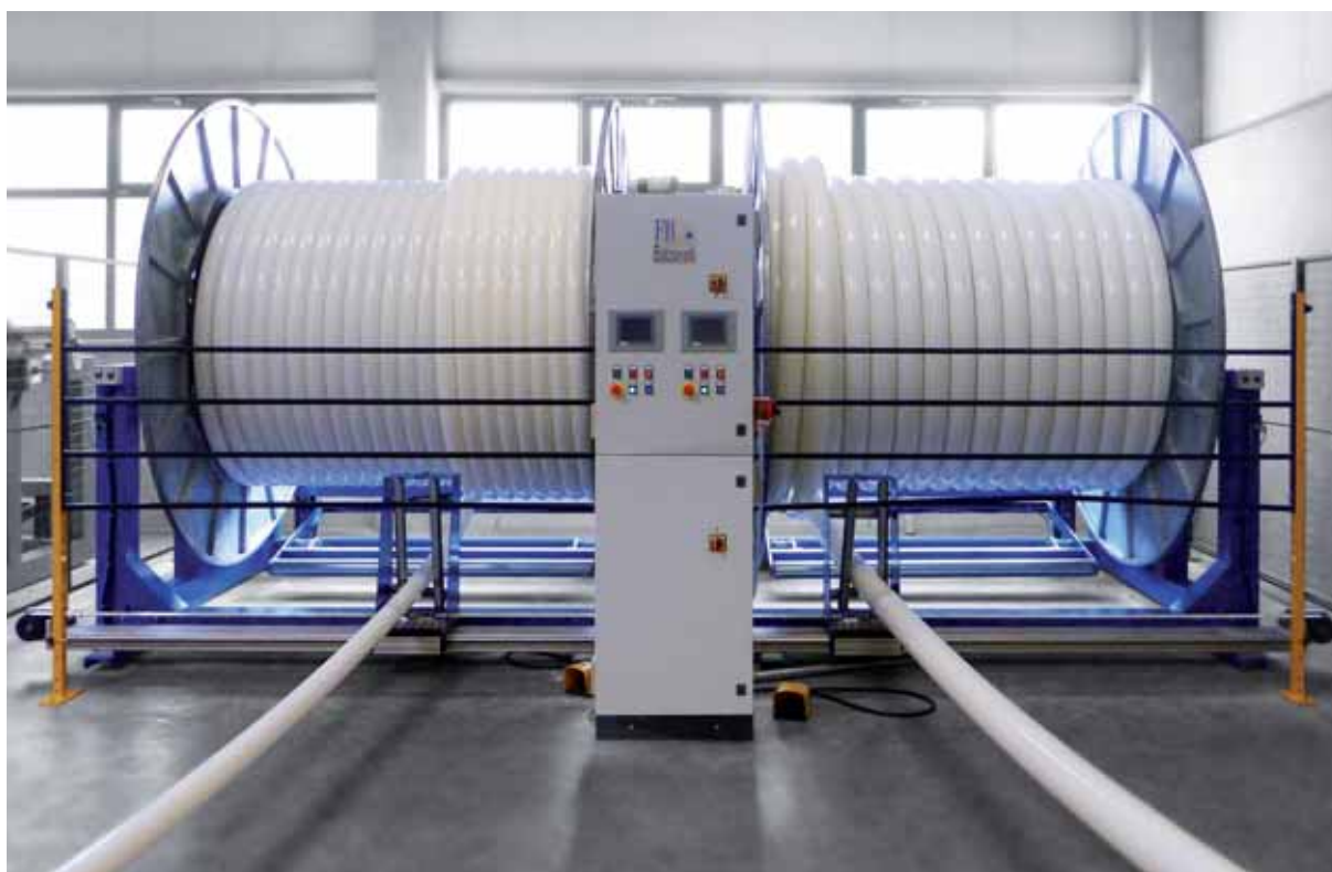
Наматывающие машины серии Drum производства FB Balzanelli предназначены для намотки труб диаметром от 4 до 160 мм на деревянные и стальные катушки
