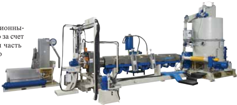
Линия GM125 Comras с системой Ecotronic и погружной резки П, разработанная компанией Gamma Meccanica для утилизации пряжи, нетканого материала и пленки ПЭТ
