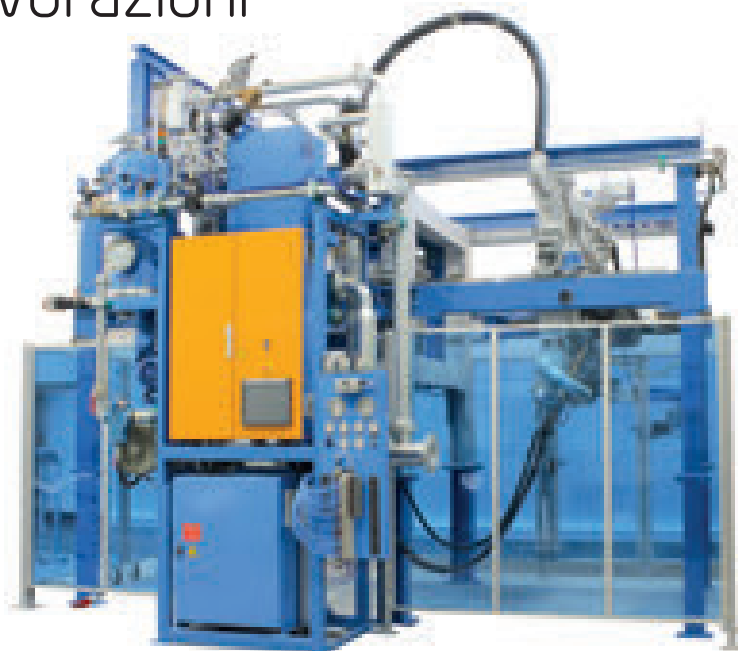
La formatrice HC 140 consente la lavorazione di EPS ed EPP, una vera novità, questa, per una macchine Hirsch
