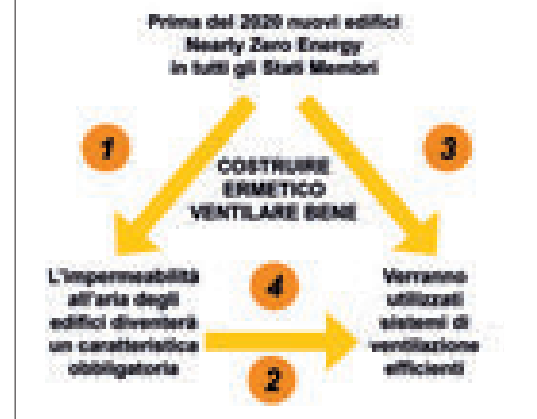
Fig. 2 - Impatto della Direttiva sull'Efficienza Energetica degli edifici sull'impermeabilità all'aria dell'involucro (Fonte: TightVent)
