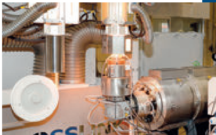
La testa RK32PEX è stata progettata, in particolare, per l'estrusione di tubi in XPEa
