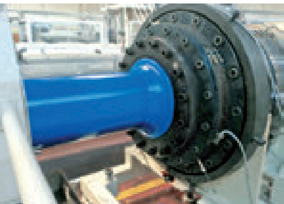
Testa a croce monostrato PO 450 CR per diametri fino a 450 mm e strati sottili di PP
