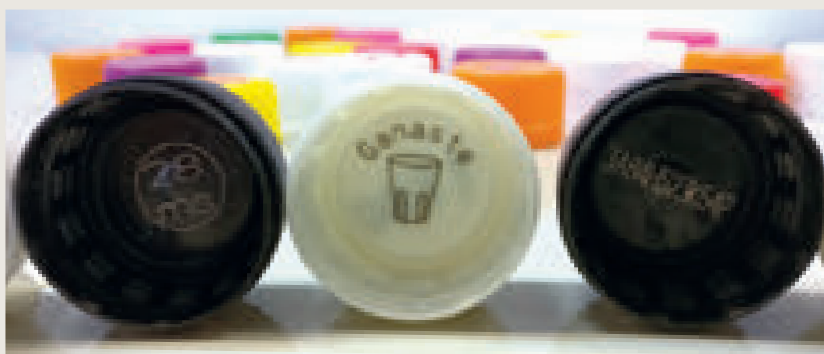
La macchina Laser Cap è stata sviluppata per marcare l'interno dei tappi con testi o immagini
