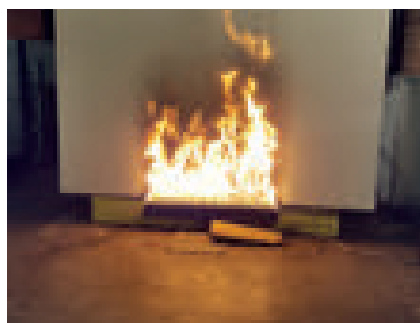
Il laboratorio LSF ha effettuato recentemente, per conto di Aipe, due prove sul sistema a cappotto con EPS (polistirene espanso sinterizzato)
