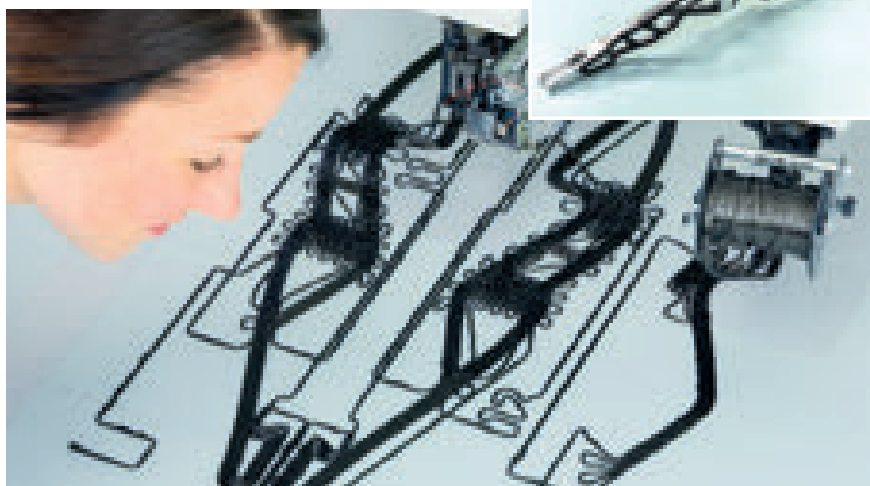
Una nuova generazione di "riser" per arco, in compositi fibrorinforzati al carbonio, è stata messa a punto dal Leibniz-Institut für Polymerforschung di Dresda, in collaborazione con la Hochschule für Technik und Wirtschaft e la Facoltà di Design
