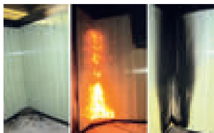
Test di resistenza al fuoco della nuova matrice poliuretanic Desmocomp di Covestro
