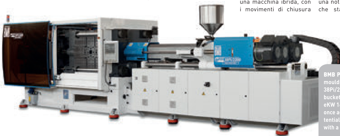
La macchina a iniezione "full electric" eKW 38Pi/2200 esposta presso lo stand di BMB a Plast 2015, dove stampa un secchio da 10 litri di capacità e 300 g di peso
